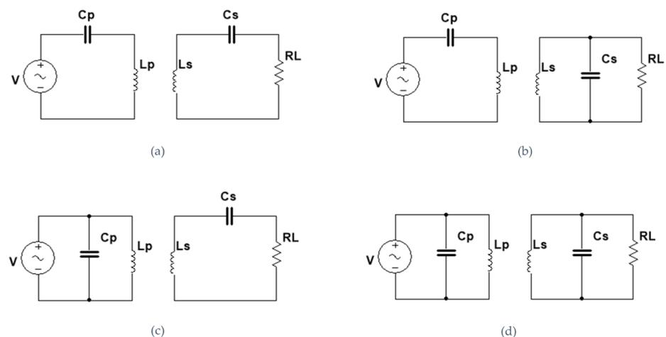
**Figure 14.** Classic or basic compensation topologies: (a) SS, (b) SP, (c) PS, and (d) PP.
